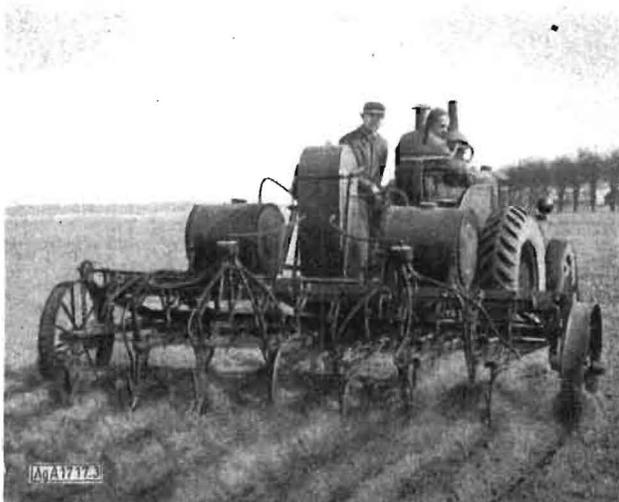
Bild 3. Verteilergerät für flüssigen Kunstdünger
