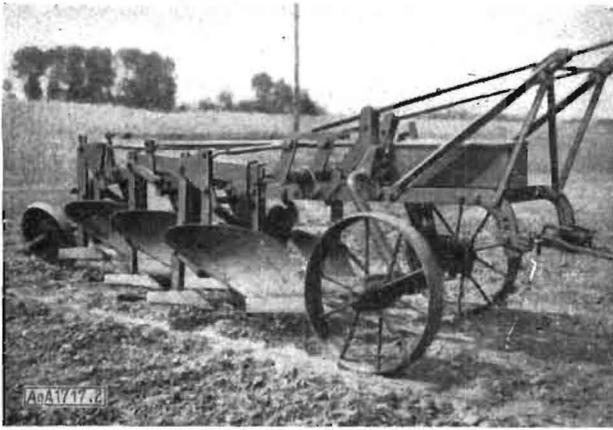
Bild 2. Schlepperanhängepflug Pc-1 mit Untergrundscharen
