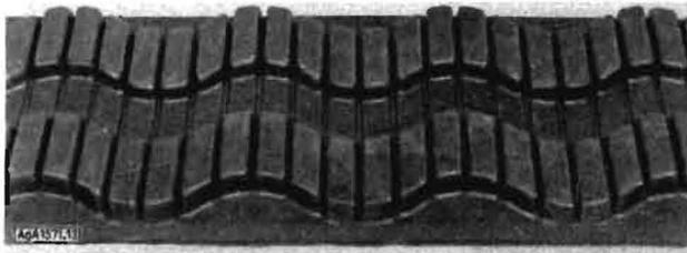
**Bild 13.** Gummigleisband mit Perloneinlage für 60-PS-Schlepper
