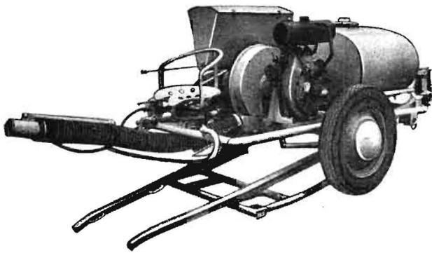
Bild 21. Sprühblaser für Gespannzug
