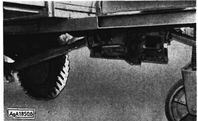
Bild 6. Anpassungsgetriebe unter der Anhängedeichsel
