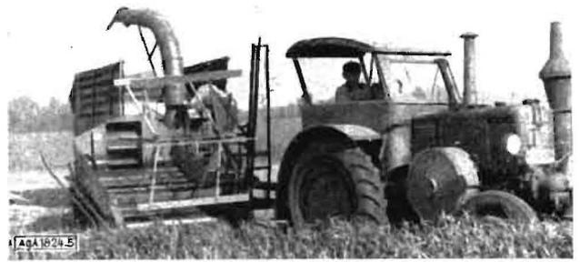
Bild 5. Heag-Feldhäcksler beim Einsatz in der Futtereroggenernte
