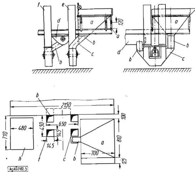
**Bild 3.** Schematische Darstellung der Aufgabe des Kornes in die Schöpfmulden der Becherwerke des Trockners SSP-2 „Kusbass“
