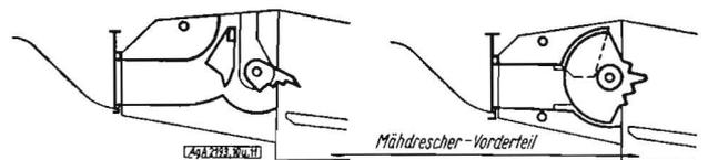
Bild 10. Mähdrescheranbaupresse mit rotierender Stroh-zuführung
