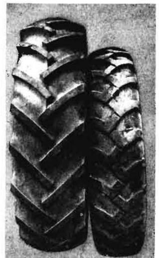
Bild 10. Vorschlag: Reifen mit großem Volumen 14-30 (34) (links) im Zuge der Ersatzbeschaffung für den „Pionier“. Rechts: alte Größe 12,75-28
