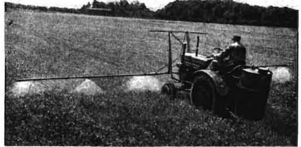
Bild 2. BLASATOR-Aufbauspritze auf einem HANOMAG
