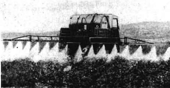
Bild 1. HOLDER-Aufbauspritze auf einem UNIMOG
