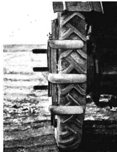
Bild 4. Greiferglieder des Kombigreifers in Greiferstellung über und neben dem AS-Luftreifen
