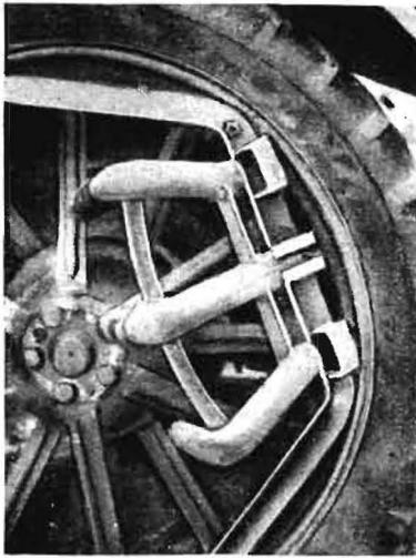
Bild 2. Ein Greiferglied des Kombigreifers, bestehend aus drei miteinander verbundenen einzelnen Greifern, im eingeklappten Zustand (Ruhestellung)
