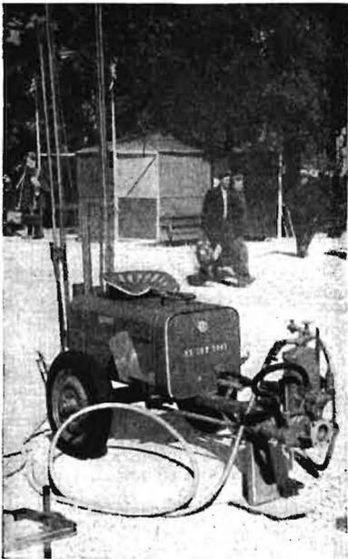
Bild 1. Fahrbares Spritzgerät zum Einachs-schlepper „Motorobot“
