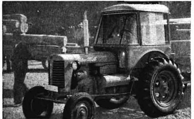
Bild 3. Niederradschlepper Zetor 25 A mit Leichtbau-Fahrerkabine (Dach und Rückwand aus Segeltuch, seitliche Schiebefenster)
