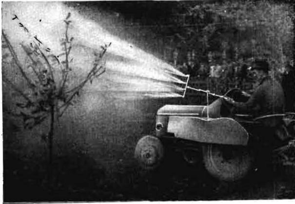
**Bild 3.** Bei der gewöhnlichen Hochdruckspritze läßt sich durch Verwendung von Spritzrohren mit je drei Düsen die Arbeit beschleunigen. In zweckmäßig gepflanzten Niederstammanlagen wird man die Strahlrohre am Schlepper halbstarr so anbringen, daß sie vom Schlepperrfahrer bedient werden können
