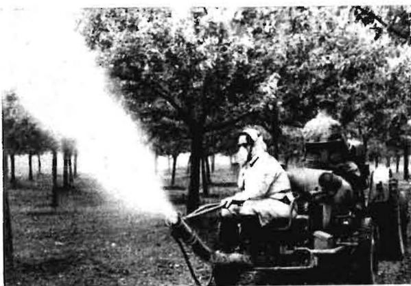
**Bild 4.** Der bewegliche Rüssel des Sprühgerätes S 621 gestattet eine sehr sorgfältige Behandlung in bezug auf die Baumformen ungleichartiger Bestände. Beim Sprühen von Spindelreihen genügt es, den Rüssel leicht federnd so zu befestigen, daß der Sprühstrahl auf die Baumkronen gerichtet ist
