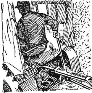
Bild 6. Unfallsicheres Fahren ergibt sich durch die Bedienung der Anhängerbremsen vom Schleppersitz aus (AID-Heft 82, S. 4)
