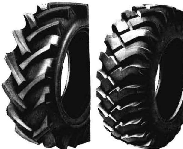
Bild 14. Gegenüberstellung eines modernen Hochstollenprofils (Conti „Farmer“) für Acker und eines „Grader“-Profils mit besonderer Eignung für Straße, Forst und Bauwirtschaft
