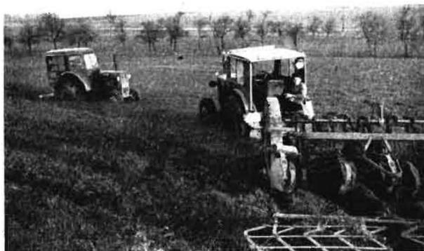
Bild 10. Infolge fehlender Einzelradbremse auf die benachbarte nasse Wiese gerutscht und versackt. Gesamtarbeitsausfall: zehn Schlepperstunden
