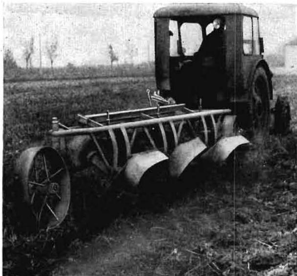
Bild 1. Der Rotorpflug System „LICHT“ beim Umbruch einer Rapsstoppel. Die Unterbringung des Bewuchses ist noch unbefriedigend
