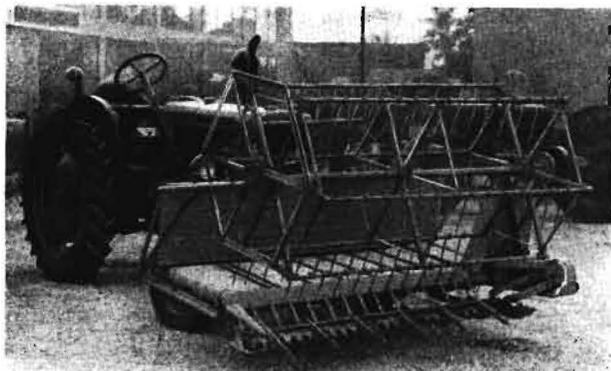
Bild 4. Der Universalschlepper U 28 mit Frontschwadmäher
