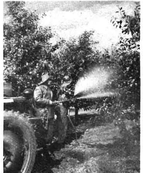
Bild 6 (rechts). Geräteträger RS 09 mit angebaute Drillingspumpe beim Spritzen
