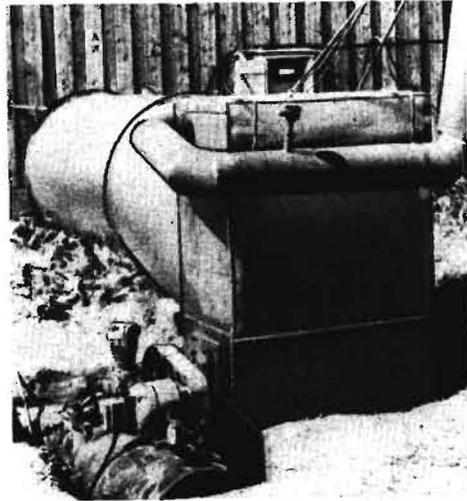
Bild 4. Ölfeuerungsgerät mit Wärmeaustauscher zum Vorwärmen der Luft
