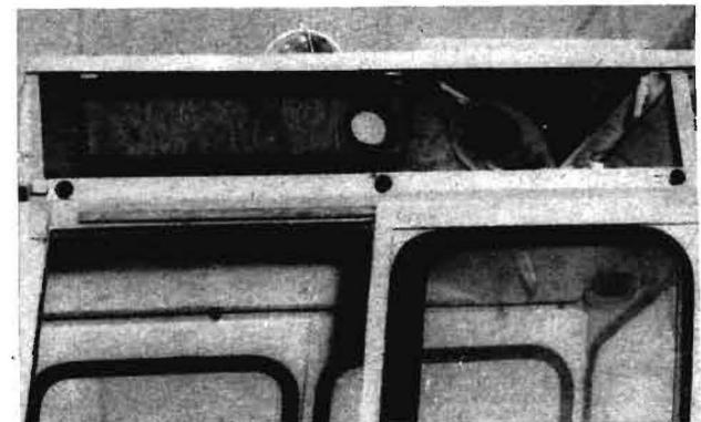
Bild 4. Im Dachraum untergebrachtes Belüftungssystem
