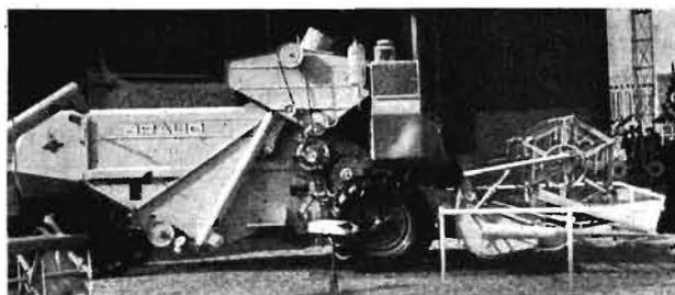
Bild 7. BRAUD-Mährescher, selbsttragend, in Leichtbauweise, lieferbar in Schnittbreiten von 2,70, 3,-, 3,50 und 4,- m. Das Stützdrück-Hinterachse-Kornbunker-Vorderachse ist deutlich erkennbar
