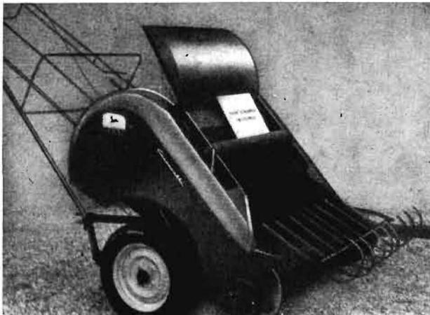
Bild 5. JOHN DEERE (THIEBAUD, Frankreich). Aufsammelpresse mit Segmentkolben und vornliegender Kurbelwelle mit rotierendem Zubringer
