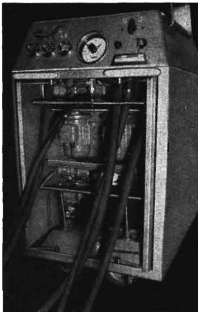
Auf der 11. Landwirtschaftsausstellung in Leipzig-Markkleeberg wurde das Ölwechsel- und Spülgerät WSG erstmalig Fachleuten der Landtechnik in seiner Wirkungsweise vorgeführt und dabei an einem RS 01/40 (Pionier) das Absaugen des Öls sowie die Umlaufspülung mit Drucköl demonstriert. Da in unserer Landwirtschaft eine Vielzahl von Traktortypen aus dem In- und Ausland verwendet wird, waren anstelle des Ablaufstutzens viele verschiedene Verschraubungen an der Ölwanne erforderlich.
