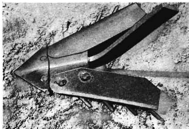
Bild 5. Umgerüsteter Häufelkörper (Typ Siedersleben). Die angeschweißten Stahlstäbe sind aus Siebkettengliedern gefertigt
