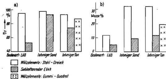
Bild 4. Absiebwirkungsgrad a) und Beschädigungswert b) der Wälzelementenroder im Vergleich zum Siebkettenroder E 649
