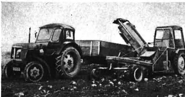
Bild 1. Aufladegerät T 272 am RS 09 mit Muldenscharen
