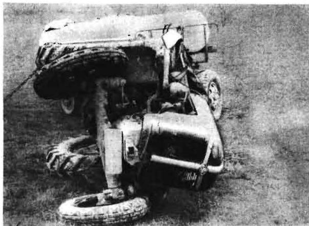
Bild 2. Hier wurde im VEG Blankenburg, Krs. Prenzlau, ein junger Traktorist ohne für einen solchen Transport erforderliche Fahrpraxis und ohne Beachtung der Arbeitsbedingungen (25% Hangneigung, Grasnarbe naß, RS 14/36 und Anhänger mit 2 Wassertanks ohne die gesetzlich geforderte Bremsverzögerung) eingesetzt. Ein Arbeitsunfall mit tödlichem Ausgang war die Folge
