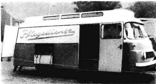
Bild 3. Pflegefahrzeug LO 2501 mit elektrisch betriebener Ausrüstung, durch die rechte Seitenklappe sind Schläuche mit Abschmier-, Reifenfüll- und Konservierungsmittelpistole zu erreichen
