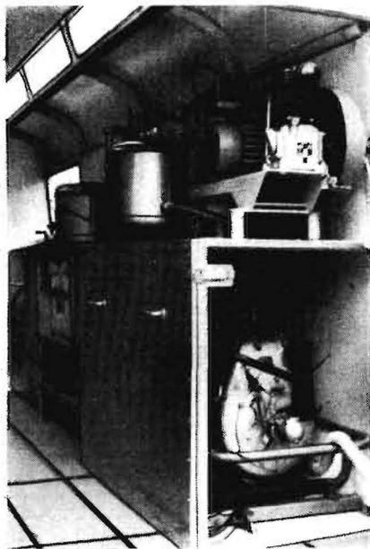
Bild 4. Pflegefahrzeug LO 2501 mit Blick auf Notstromaggregat, Kompressor, Konservierungseinrichtung, Abschmiergerät AG 2 und Starterhilfe
