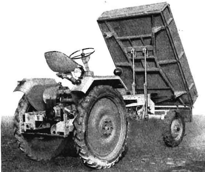
Bild 35. RS 27, Hofschlepper mit nach drei Seiten kippbarer Ladepritsche
