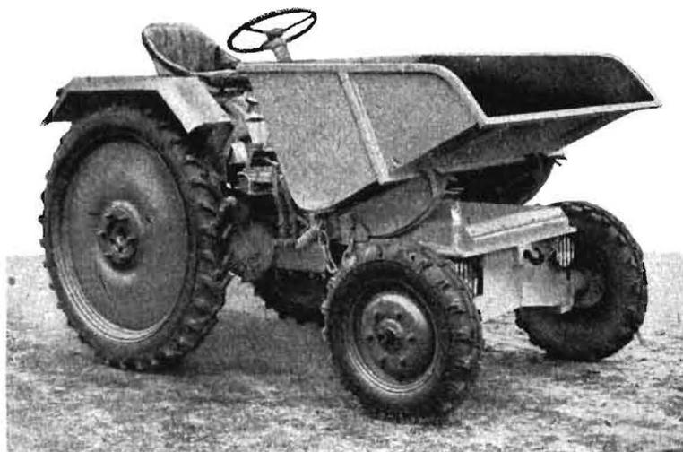
Bild 36. TA 25, Dumper mit  $0,75 \text{ m}^3$  Kübelinhalt
