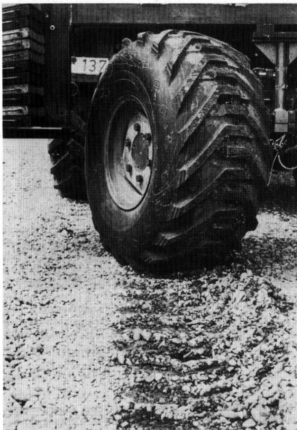
Bild 7. Gelenkter Terra-Reifen auf dem Kiesboden.
