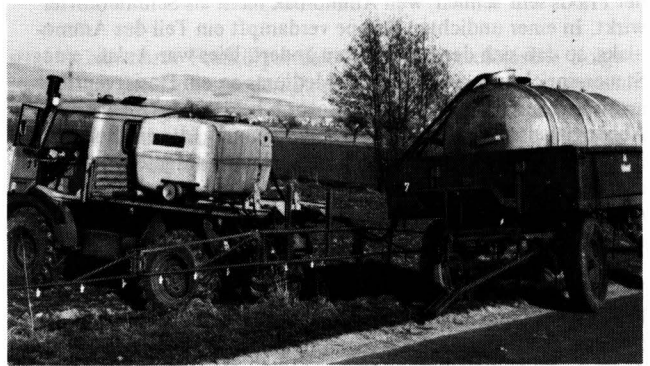
Bild 3. Die Umfüleinrichtung der Spritze oder eine gesonderte, leistungsfähige Pumpe fördert die N-Lösung aus dem Versorgetank in den großen Gerätebehälter.
