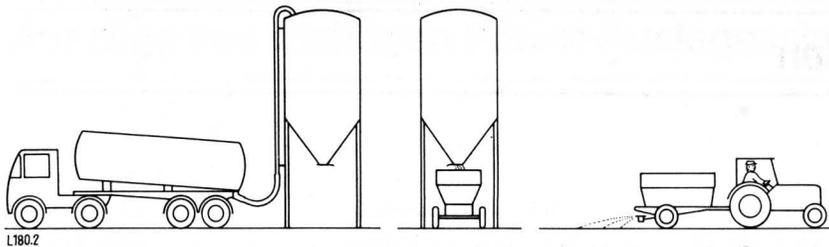
**Bild 2.** Arbeitskette für staubfeinen Lose-dünger bei großem Verbrauch.
