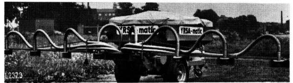
Bild 3. Pneumatischer Streuer.
