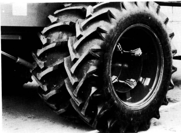
Bild 7. Zwillingbereifung, kombiniert aus Größe 24,5-32 und 18,4-38.
