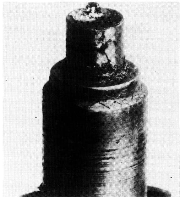
**Bild 9.** Einspritzdüse mit Ablagerungen nach 100 h-Dauerversuch mit rohem Rapsöl bei teilweisem Unterbinden der Luftkühlung.
