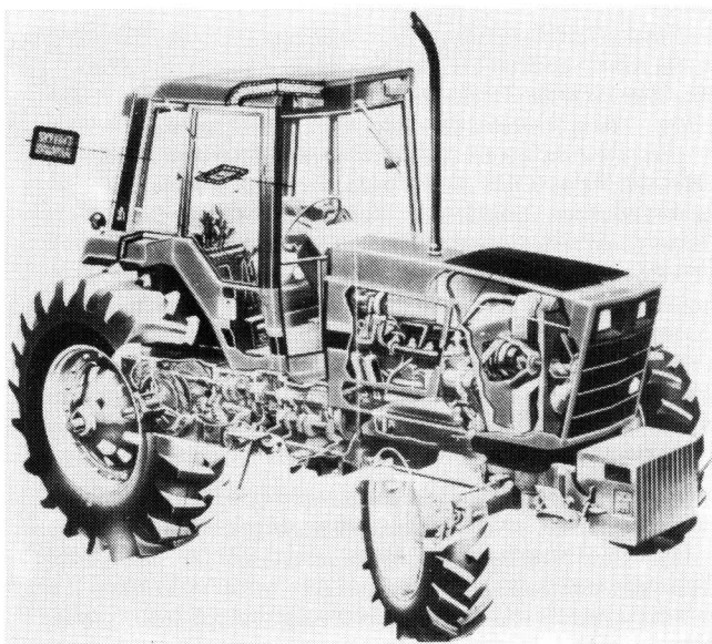
Bild 5. Konzeption für eine Sicherheitskabine aus Sandwich- und Kunststoffelementen.
