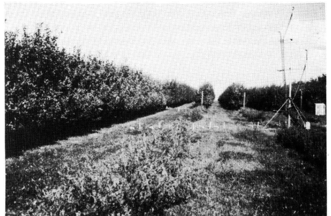
Bild 1. Aufbau der Abdriftmeßeinrichtungen auf der leeseits angrenzenden Freifläche; Erfassung des Bodensediments mit Weithalsgläsern, Bestimmung der atmosphärischen Drift über an einem Teleskopmasten montierte Ansaugsonden.
