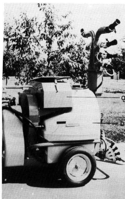
Bild 5. Seitenansicht des kombinierten Sprüh- und Stäubegerätes (TP 455) der Firma Tecnom, Neustadt/W.; die Ausblasöffnungen (unten 4-Finger-Düse, oben einzeln verstellbare Öffnungen) können beim Wechsel der Ausbringungsart (Sprühen/Stäuben) in ihrer Einstellung verbleiben.
