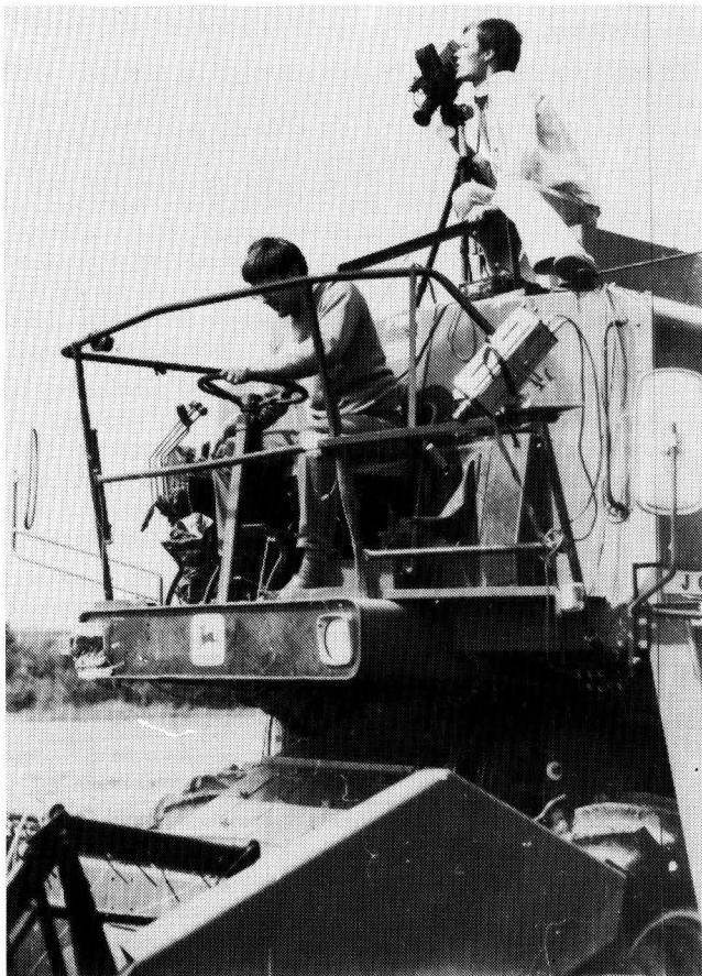
Bild 1. Mähdrescher mit Aufnahmeeinrichtung während des Versuchseinsatzes.
