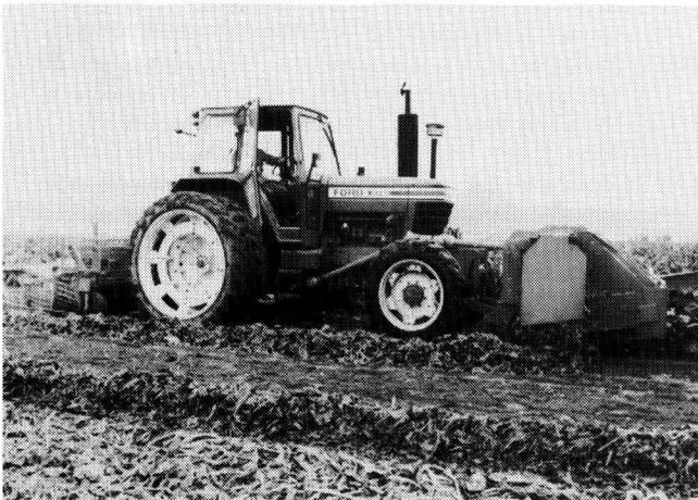
Bild 1. Kopplung von Arbeitsgängen durch die Nutzung von Heck- und Frontanbau.
