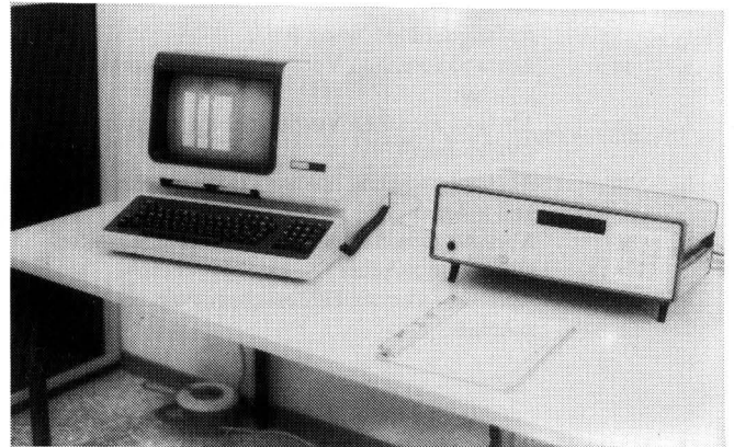
Bild 2. Prozeßrechner zur Steuerung der Funktionsabläufe und Personal-Computer zur Datenspeicherung.
