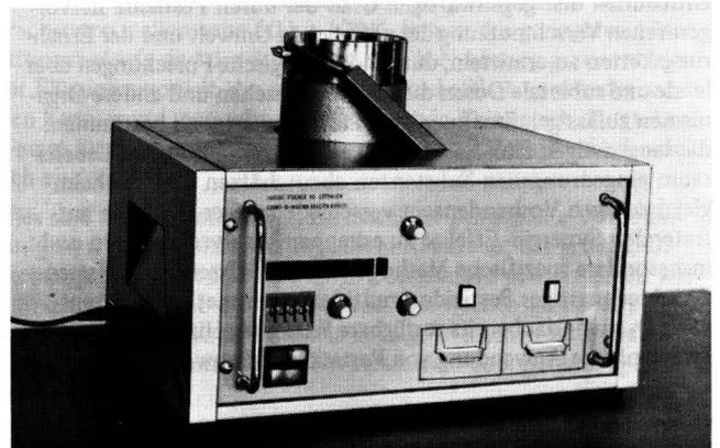
Mit Hilfe elektrischer Geräte kann man im Mittel die fünffache Probenmenge gegenüber Handarbeit zählen; sie erreichen bei umfangreicheren Proben höhere Zählfrequenzen. Mittlere und große Samen lassen sich mit Fehlern  $< 0,1\%$  zählen, bei Feinsämereien zeichnet sich bei  $0,2\%$  die Fehlergrenze ab. Samenarten, die sich manuell schlecht zählen lassen, führen auch bei elektrischen Geräten zu schlechten Zählergebnissen.
