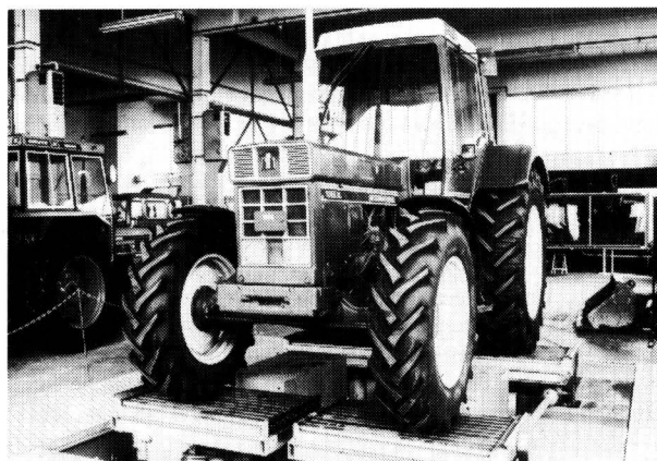
Bild 1. 4-Stempel-Hydropulsanlage mit Rollenkästen.
