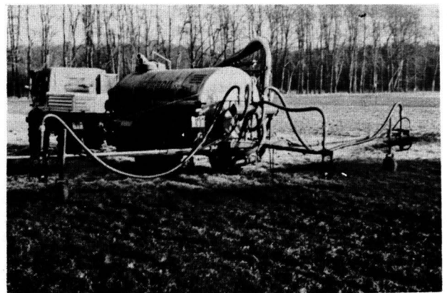
Bild 5. Versuchstankwagen mit aktivem 12 m-Breitverteiler.
