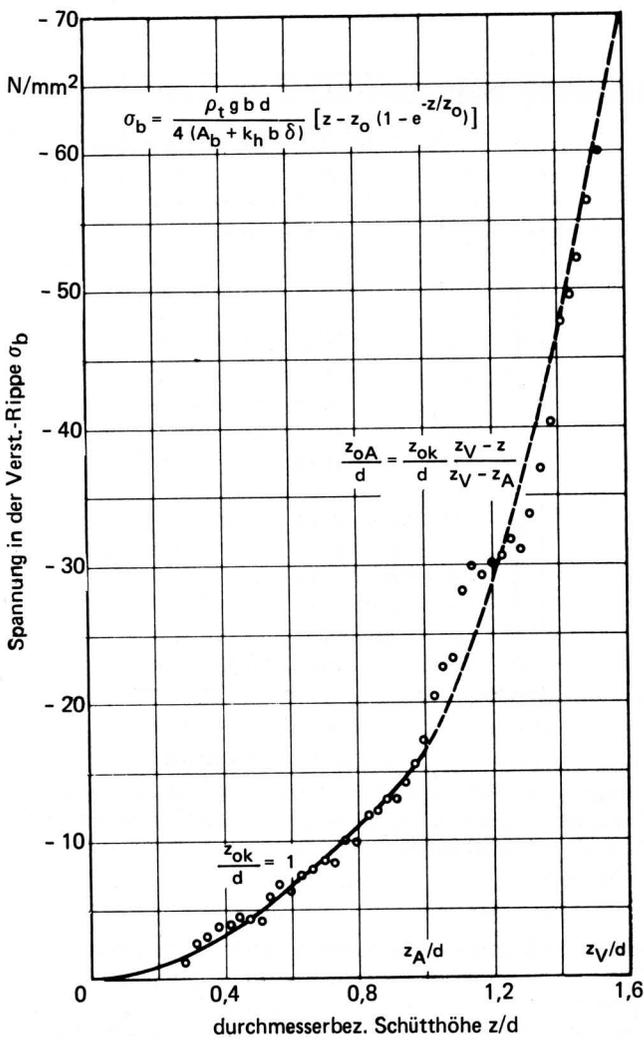
Bild 5. Spannungen in den Versteifungsrippen in Abhängigkeit von der auf den Silodurchmesser bezogenen Höhe der Schüttung.
