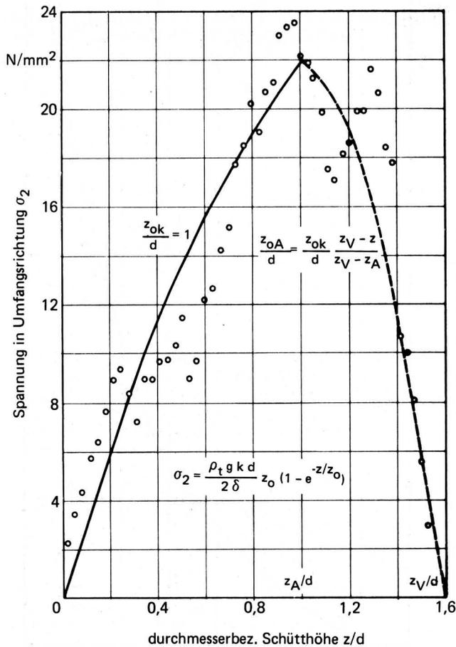
**Bild 7.** Spannungen in der gewellten Schale in Umfangsrichtung in Abhängigkeit von der auf den Silodurchmesser bezogenen Höhe der Schüttung.
