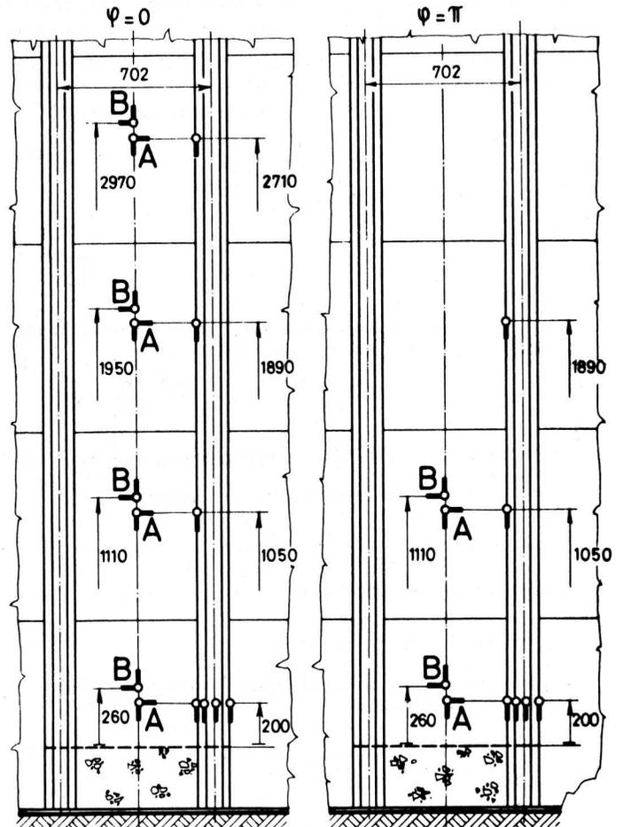
**Bild 4.** Anordnung der Meßstellen für die Dehnungsmessung.
