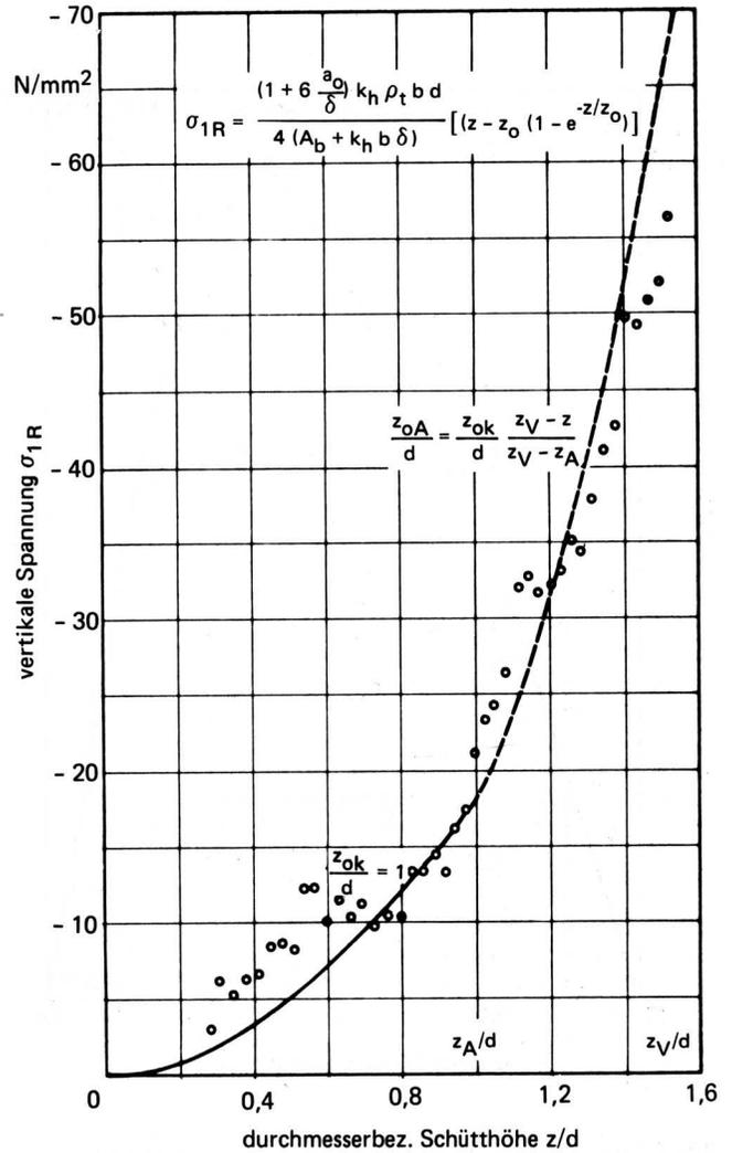
Bild 6. Vertikale Spannungen in der Randfaser der gewellten Schale in Abhängigkeit von der auf den Silodurchmesser bezogenen Höhe der Schüttung.
