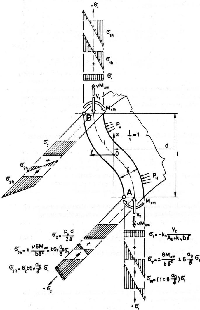
**Bild 3.** An der gewellten Schale wirkende Belastungen und dadurch hervorgerufene Spannungen.
