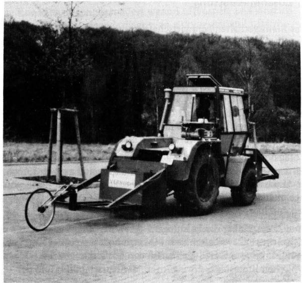
Bild 11. Bremsversuche mit einer Versuchseinrichtung zur Änderung des Massenträgheitsmoments des Schleppers.
