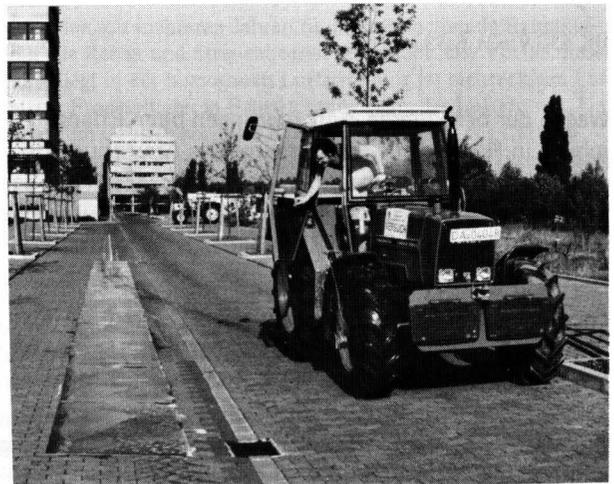
Bild 12. Allradschlepper mit Kardanwellenbremse nach Bremsversuch auf einseitig glatter Fahrbahn.
