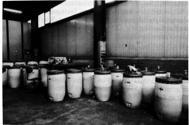
Bild 2. Konservierungsversuche in 120 l-Kunststoffässern.
