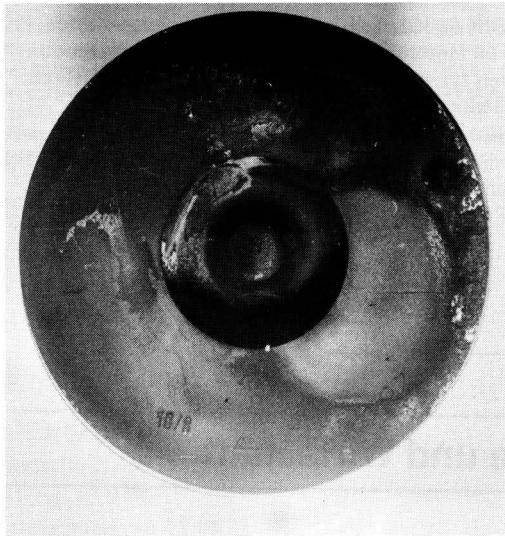
Bild 11. Kolben nach 300stündigem Betrieb mit Methyl-ester von Rapsöl; Einzylindermotor mit direkter Einspritzung.
