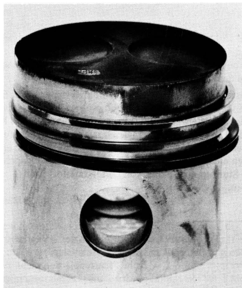
Bild 8. Kolben nach 50stündigem Betrieb mit raffiniertem Rapsöl; Einzylindermotor mit Vorkammer.
