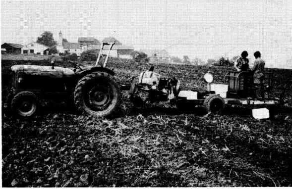
Bild 12. Fahrbare Einrichtung (Schollensiebgerät, Waage) zur Auswertung der Bodenproben.
