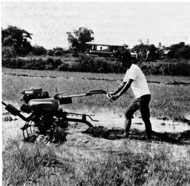
**Bild 3.** Einachsschlepper bei der Reisfeldbestellung.
