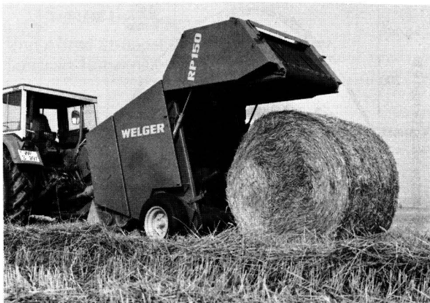
Bild 6. Rollpresse mit konstantem Preßraum, Ballen mit Sternstruktur und fester Außenschicht. (Werkbild Welger).
